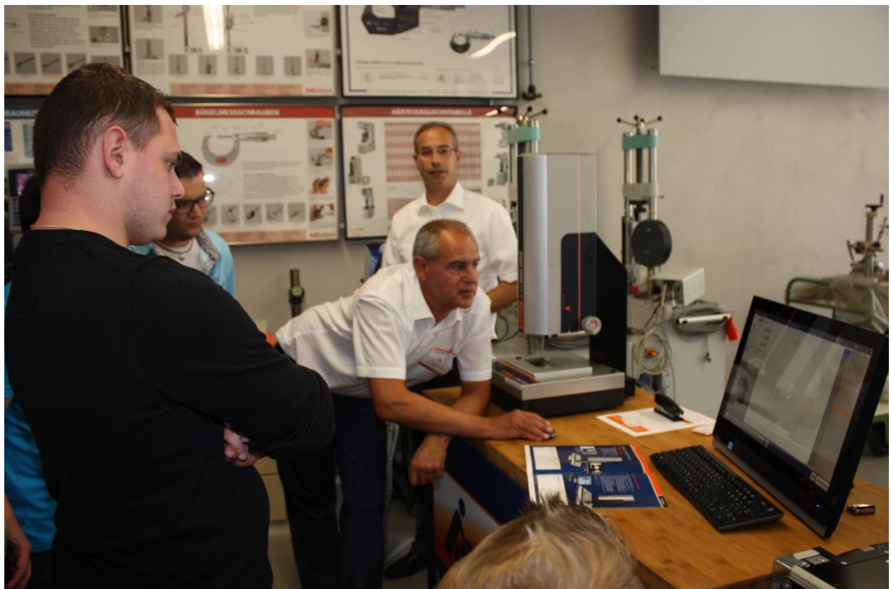
Harald Wohlfahrt, Messtechniker von der Hoffmann Group, führt 2D-Messen in Millisekunden an einem GARANT Video-Messmikroskop vor.
